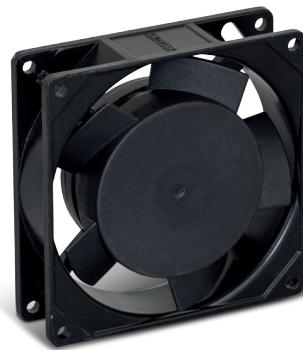
La serie Y è composta da ventilatori a rotore esterno, 2 poli con cuscinetti a sfera (T. A. -20 +60°C). La serie comprende ventilatori quadrati aventi dimensioni esterne da 80x80 mm a 120x120 mm con potenze da 9 a 18 W; e ventilatori rotondi con diametro 150 e 220 mm con motori da 34 e 45 W.
