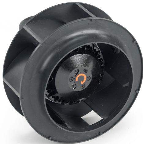
Sono ventilatori a rotore esterno di tipo centrifugo a pale avanti. Sono disponibili in diametri da 133 a 280mm; 2 poli, monofase con tensione di alimentazione 230V, 50Hz, classe B, IP44 termoprotetto. Possono lavorare in ambienti con temperatura da -25°C a +60°C e generare portate da 180 a 1600 m<sup>3</sup>/h.
