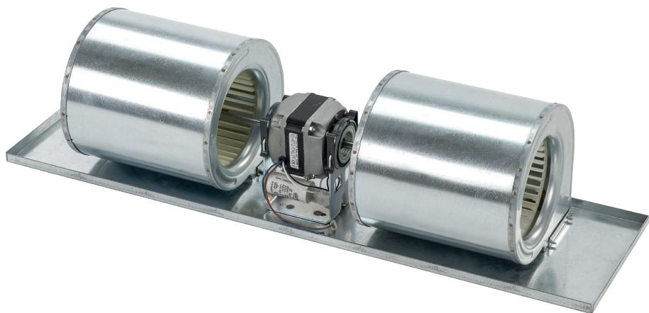
Le unità motoventilanti serie DCK comprendono unità mono o bicoclea. Possono avere da 1 a 6 velocità in cava, oppure con l'ausilio dell'autotrasformatore. Sono motori protetti termicamente, classe di isolamento B o F, IP42.
