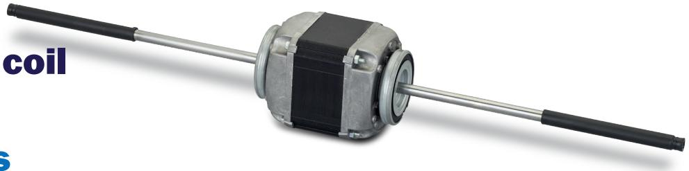
Sono motori elettrici a bronzine, avvolti su lamiera 82x82, asincroni, monofase, 4 poli, 5 velocità in cava o dotati di autotrasformatore ed entrambi a condensatore permanentemente inserito (PSC). Sono motori termoprotetti classe B con grado di protezione IP42. Le potenze rese vanno da 15 a 55W, alimentati a 230V 50/60 Hz. Sono disponibili in versione mono e bisporgente e personalizzabili su richiesta.
