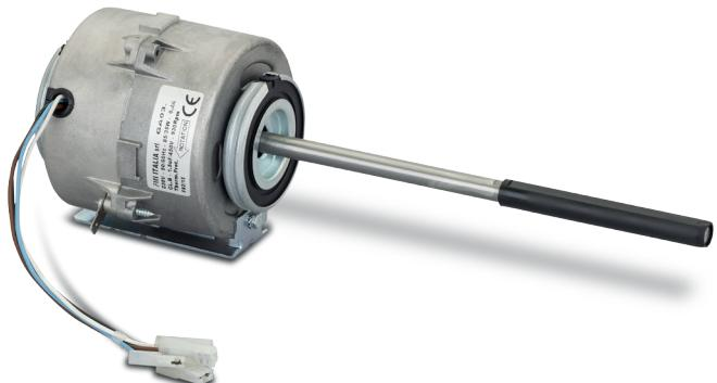
Sono motori elettrici a bronzine, avvolti su lamiera diametro 90, asincroni, monofase, 4 poli, fornibili con autotrasformatore 7 velocità a condensatore permanentemente inserito (PSC). Sono motori termoprotetti classe B con grado di protezione IP42. Le potenze rese vanno da 35 a 50W, alimentati a 220/240V 50/60 Hz. Sono disponibili in versione mono e bisporgente e personalizzabili su richiesta.
