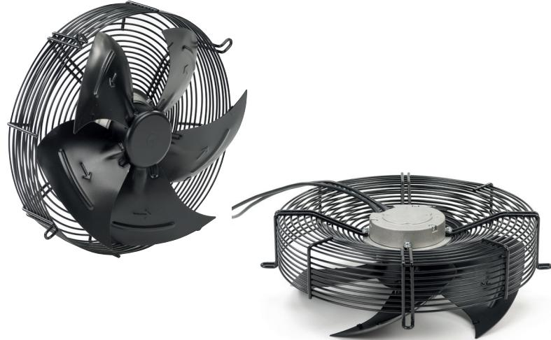
I ventilatori assiali elettronici sono disponibili nei diametri da 250mm a 900mm con tensione di funzionamento 230/380/400VAC - 50/60Hz isolati in classe F, IP44 o IP54. Sono disponibili portate d'aria da 1960m<sup>3</sup>/h a 32900m<sup>3</sup>/h a 0 Pa.
