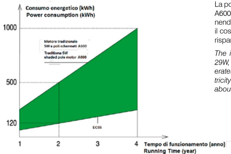
La potenza in entrata di un motore a poli schermati tradizionale A600 è 29W, la potenza in entrata di un EC05 è 5,4 W; supponendo che il motore funzioni 24 ore/giorno e 365 giorni/anno e il costo per l'energia elettrica è 0,23 euro/kWh, ogni EC05 può risparmiare, in elettricità, circa 45 euro l'anno.
